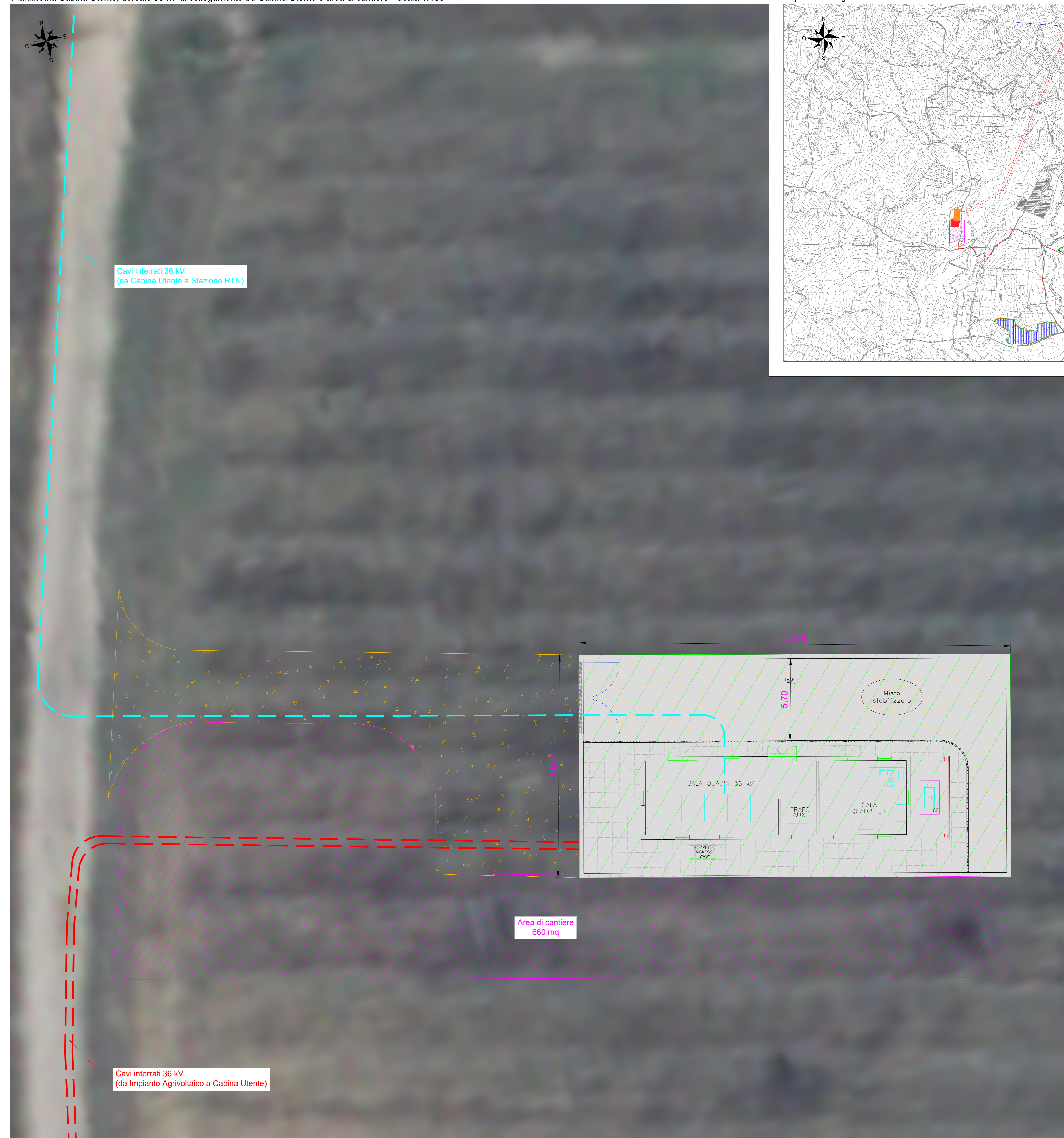
Planimetria Cabina Utente, dorsale 36 kV di collegamento tra Cabina Utente e area di cantiere - Scala 1:100
