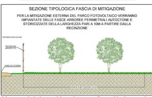
Schema tipologico del sistema di mitigazione visuale. Il sistema costituito da essenze arboree autoctone. La fascia arborea ampia circa 10 metri sarà disposta con essenze piantumate a quinquennale.
