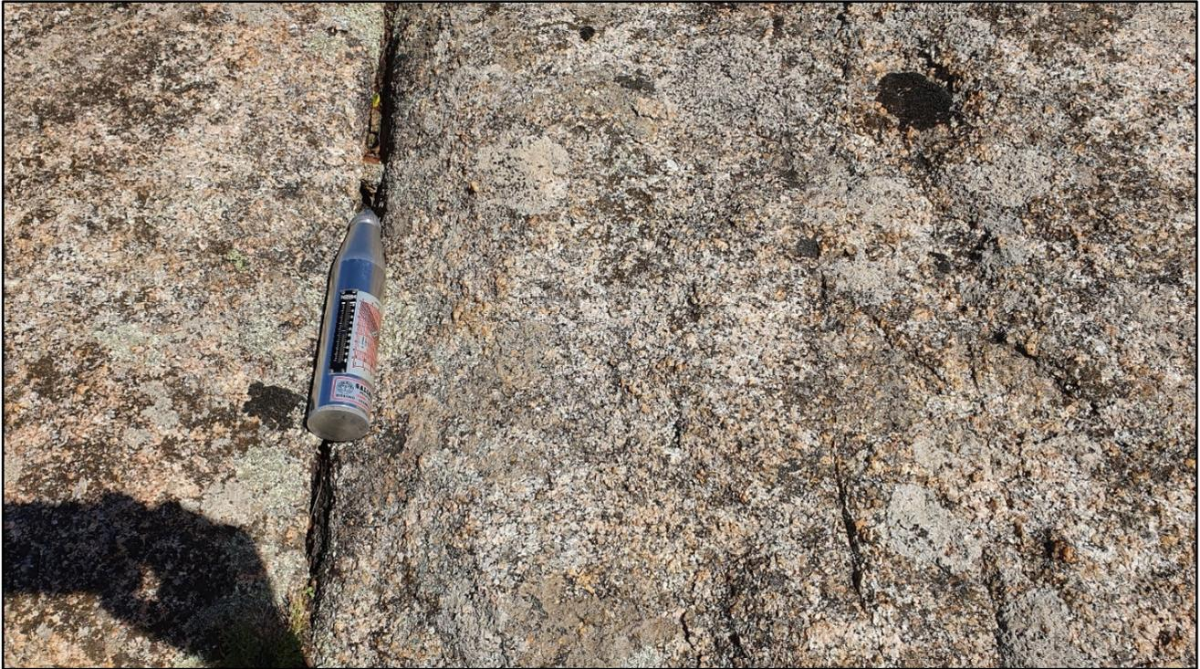
Foto 1 – Prove sclerometriche eseguite sull'affioramento roccioso granitoide in una delle stazioni di misura
