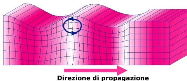
*Fig. 18 - Rappresentazione grafica della propagazione delle onde superficiali di Rayleigh caratterizzata dall'oscillazione polarizzata in un piano verticale e con movimento delle particelle retrogrado rispetto alla direzione di propagazione dell'onda.*
