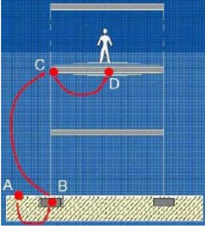
Figura 3.1 - Schematizzazione semplificata della propagazione delle vibrazioni nel sistema terreno-edificio
