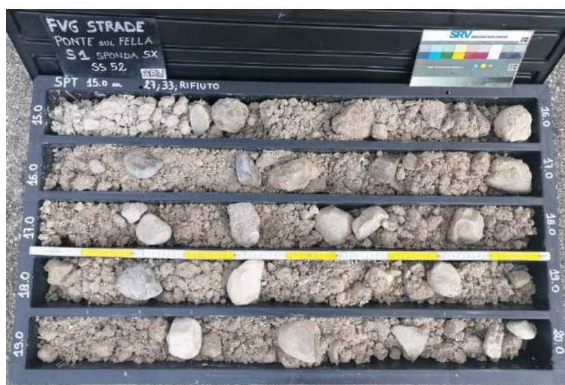
Foto n. 1: sondaggio S1 cassetta C4 da 15.0 a 20.0 metri Terreno campionato: alluvioni ghiaioso sabbiose con ciottoli e trovanti
