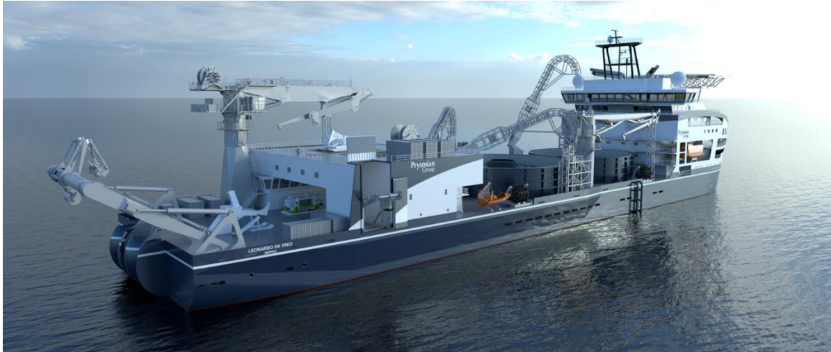
Figura 2.15: Nave posa cavo Leonardo Da Vinci [Fonte: Prysmian Group S.p.A., Fincantieri S.p.A.-Vard Group]
