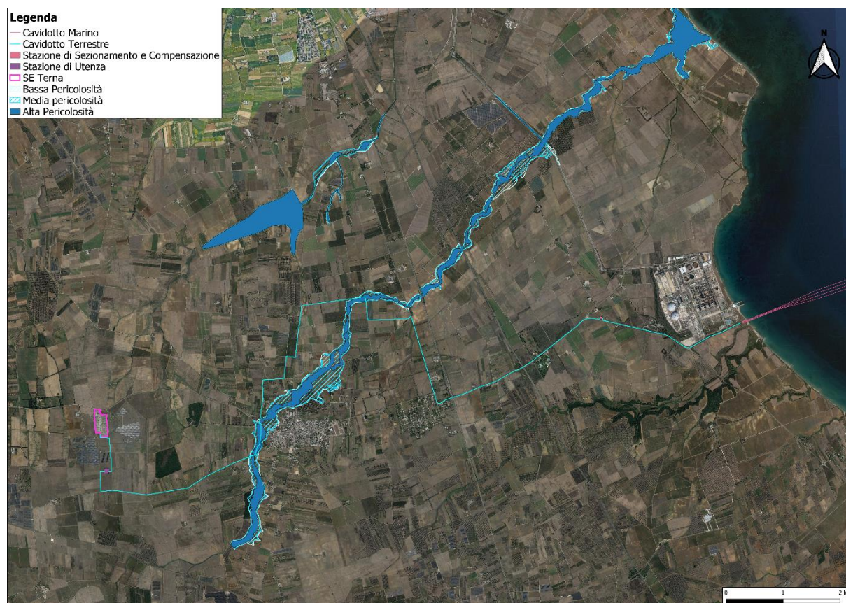
Figura 5.95: Inquadramento opere di progetto Onshore rispetto alla Pericolosità Idraulica. Fonte: Autorità di Bacino Distrettuale dell'Appennino Meridionale
