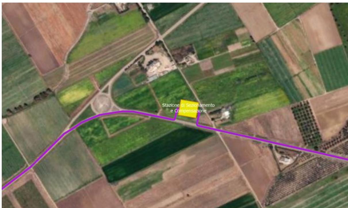
Figura 4.6: Inquadramento della Stazione di Sezionamento/Compensazione
