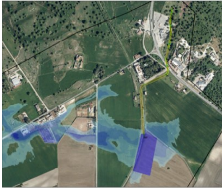
Mappa delle aree allagabili per T_R = 200 anni, post-operam da simulazione idraulica di progetto Fonte elaborato "Relazione Paesaggistica" codice T00IA01AMBRE01A
