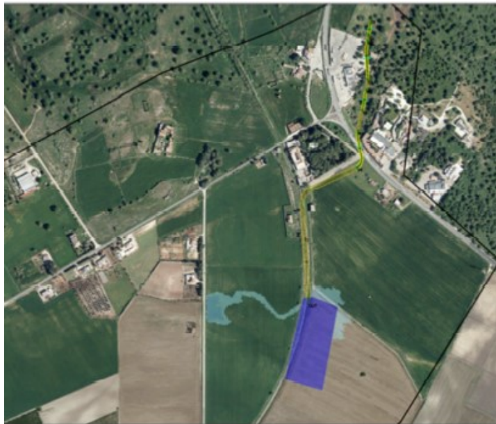
Mappa delle aree allagabili per T_R = 30 anni, post-operam da simulazione idraulica di progetto Fonte elaborato "Relazione Paesaggistica" codice T00IA01AMBRE01A
