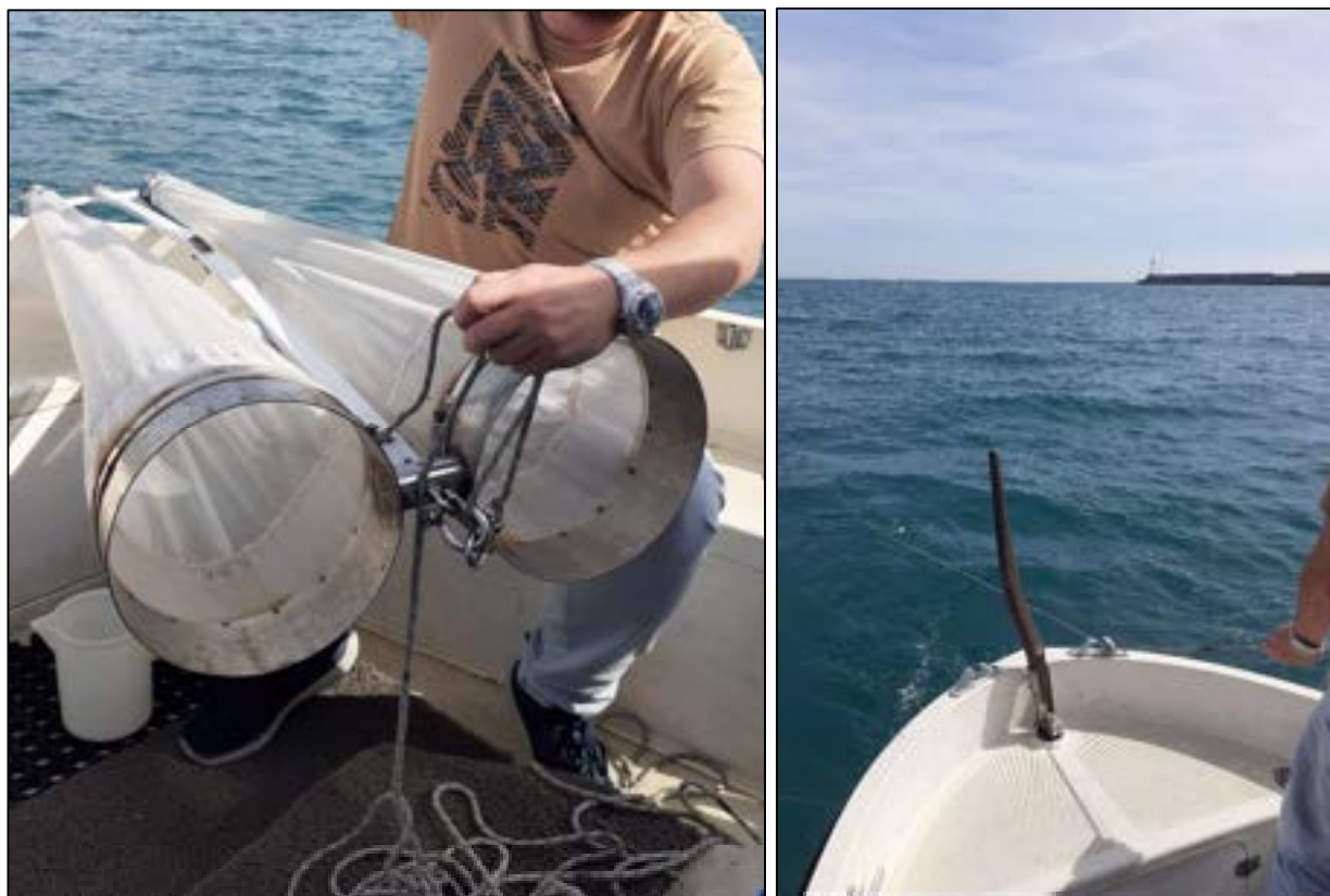
Figura 4: campionamento con retino bongo a bordo e in fase di trascinamento lungo il transetto previsto dal Piano di Monitoraggio
