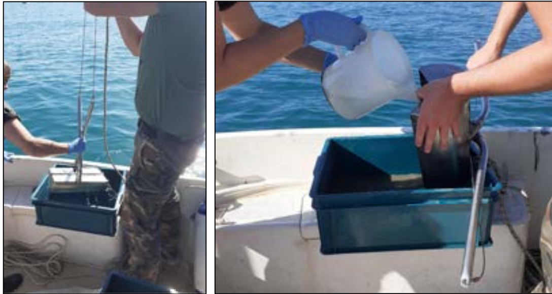
Figura 1: campionamento con benna Van Veen
