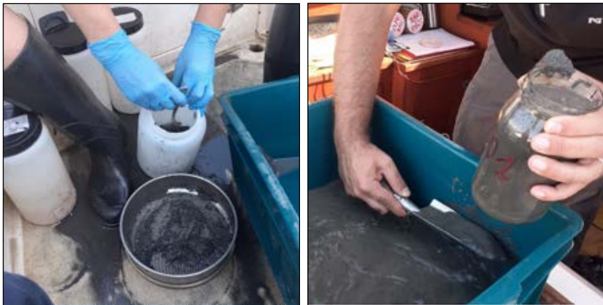
Figura 2: a sinistra setacciatura preliminare dei sedimenti per l'analisi dei popolamenti bentonici, a destra prelievo di un campione per l'analisi dei parametri chimici
