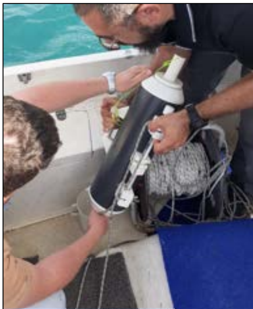
Figura 3: campionamento con bottiglia oceanografica Niskin, in fase di armatura
