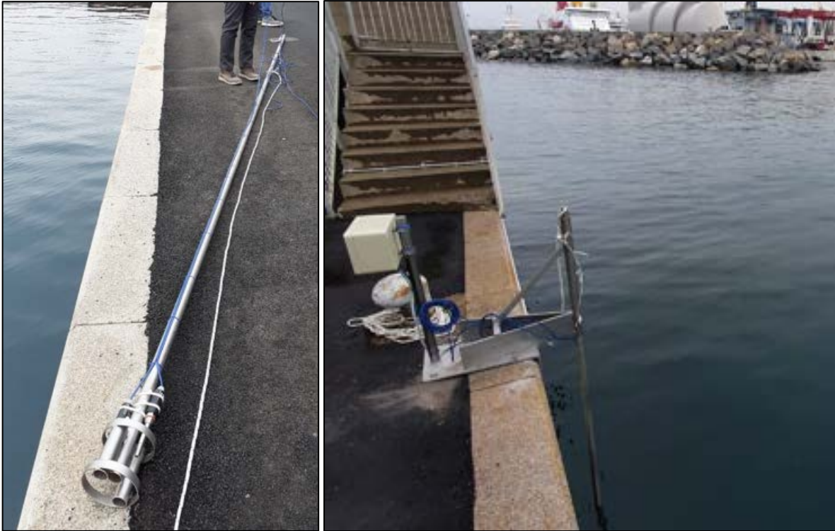
Figura 21 a sinistra il palo in acciaio inossidabile in tutta la sua lunghezza alla cui estremità sono state agganciate le sonde, a destra la struttura di allaccio alla banchina
