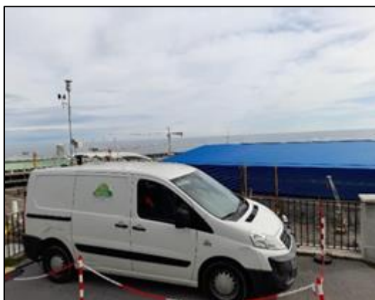
Figura 15 – Stazione meteorologica presso l'unità mobile di monitoraggio della qualità dell'aria a Villa Croce
