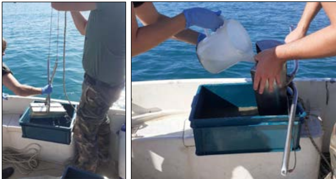
Figura 1: campionamento con benna Van Veen
