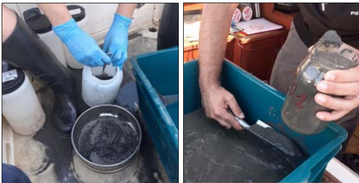
Figura 2: a sinistra setacciatura preliminare dei sedimenti per l'analisi dei popolamenti bentonici, a destra prelievo di un campione per l'analisi dei parametri chimici
