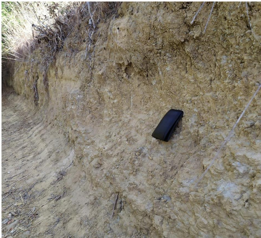
Figura 5.7 - Formazione del Cixerri, affiorante a est della WTG P05 (coordinate 455424.16 m E- 4341877.70 m N). Litofacies delle arenarie, qui debolmente cementate
