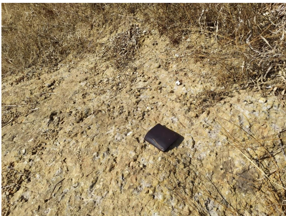
Figura 5.11: Formazione del Cixerri, affiorante a est della WTG P05. Litofacies delle arenarie, qui ben cementate e in parte conglomeratiche, con buona resistenza meccanica. Coordinate 455422.64 m E- 4341867.38 m N.
