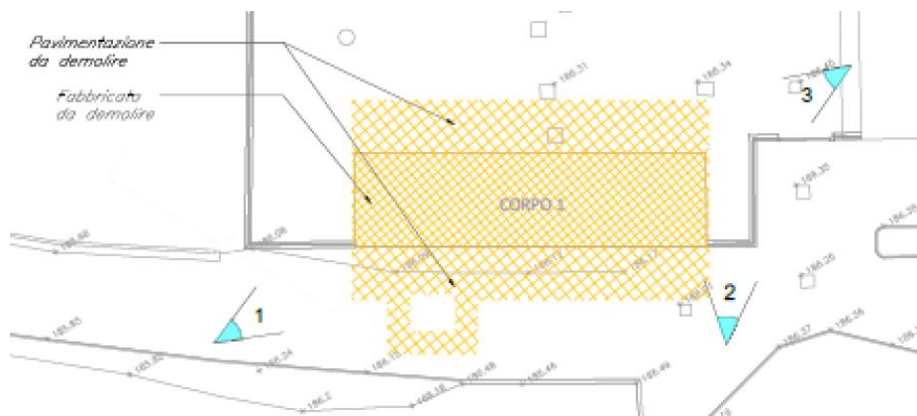
Figura 3-3 - Demolizioni area Piazzale RI63 PE
