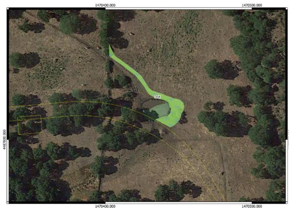
**Figura 8 - Localizzazione degli interventi di compensazione relativi alla realizzazione di nuovi habitat (in verde) connessi alla esistente zona umida nei pressi dell'accesso alla AG\_05. I valori numerici indicati all'interno del poligono si riferiscono alla relativa superficie in m<sup>2</sup>. In giallo: layout impianto.**
