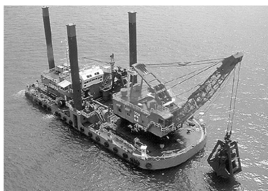
Figura 7-2 - Moto-nave pontone: A sx escavatore idraulico a braccio rovescio; A dx escavatore tralicciato a funi
