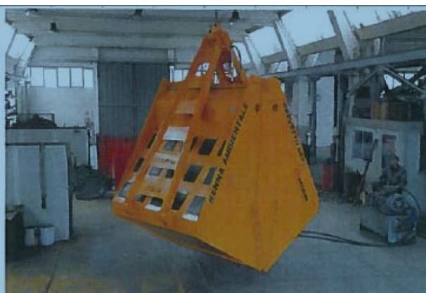
Figura 7-3 Benna ecologica: A sx in posizione di apertura; A dx in posizione di chiusura.
