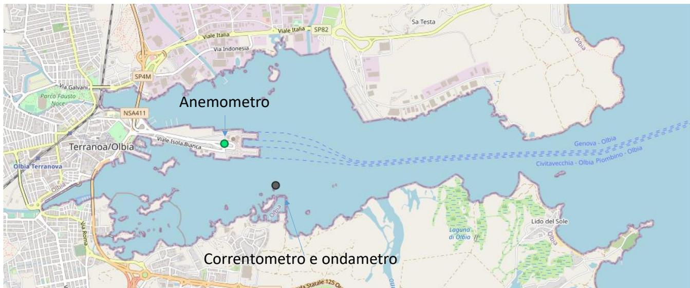
Figura 6-2 - Posizionamento del correntometro, dell'ondametro e dell'anemometro che hanno rilevato le misure fornite dall'AdSP.
