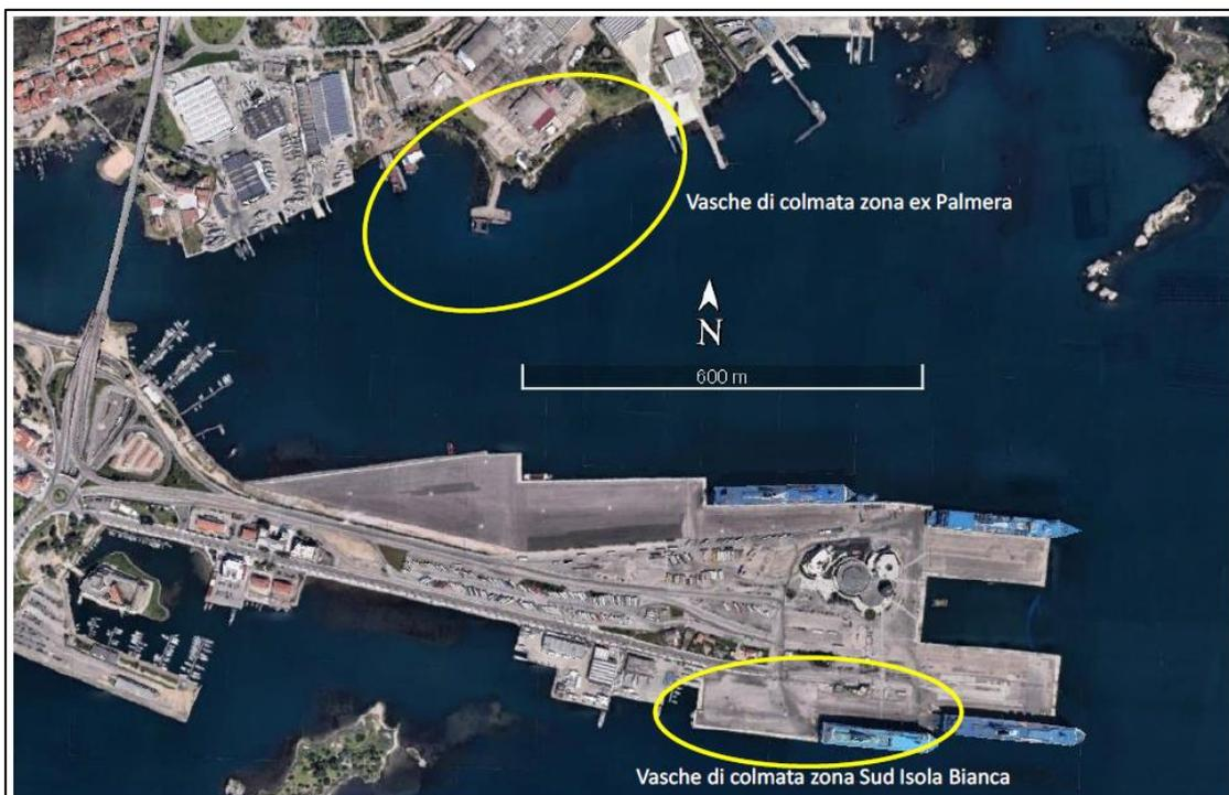
Figura 17. Localizzazione indicativa delle vasche di colmata in previsione
