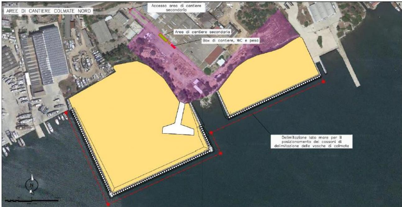
Figura 26. Area di cantiere delle Colmate Nord (Fonte: Prime indicazioni e disposizioni per la stesura dei piani di sicurezza)
