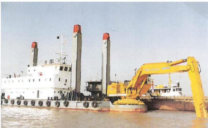
Figura 11. Motonave pontone con escavatore idraulico a braccio rovescio a sinistra e con escavatore tralicciato a funi a destra
