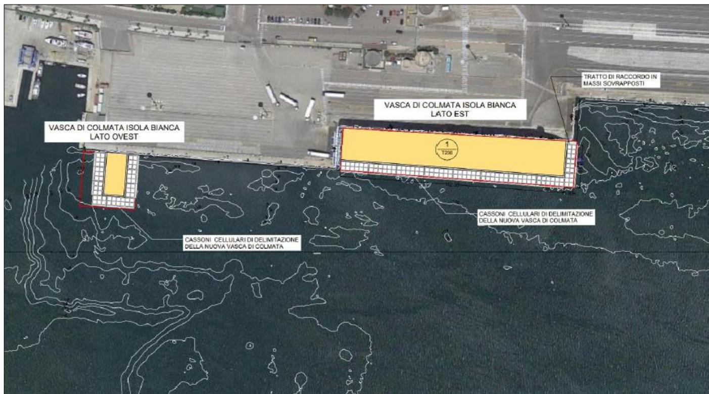
Figura 3-5 - Dettaglio delle vasche di colmata in corrispondenza dei moli 8 e 9 (estr. da Rel. Gen. PFTE 2023: fig. 4-2).
