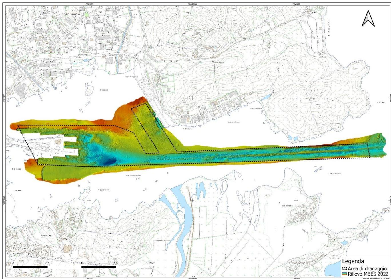
Figura 4-2 - Rilievo MBES dell'area di progetto eseguito nel 2022 (el. GIS ASPS da indagini 2022).
