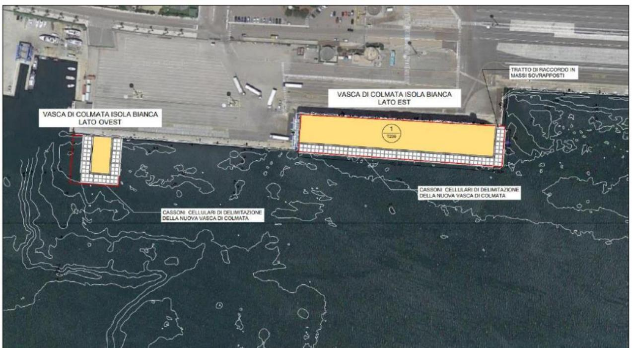
Figura 12: Vasche di colmata Isola Bianca (Fonte: Relazione Generale PFTE)
