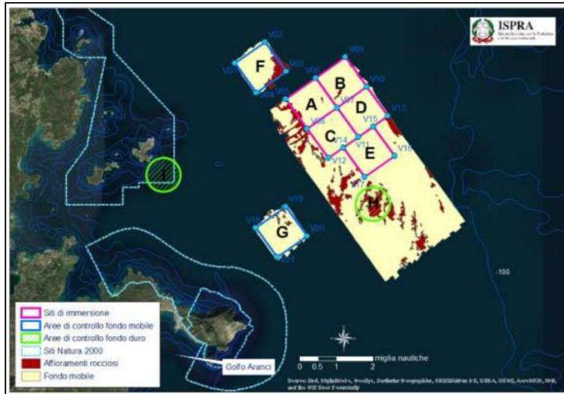
Figura 14. Rappresentazione GIS del possibile sito di immersione (A,B,C,D, E) con le aree di controllo del fondo duro (H, I) e molle (F, G). Fonte: Studio di fattibilità dell'area di immersione dei sedimenti da dragare nel Porto di Olbia. Convenzione ISPRA – AdSP del Mar di Sardegna – Report 2 - Luglio 2021
