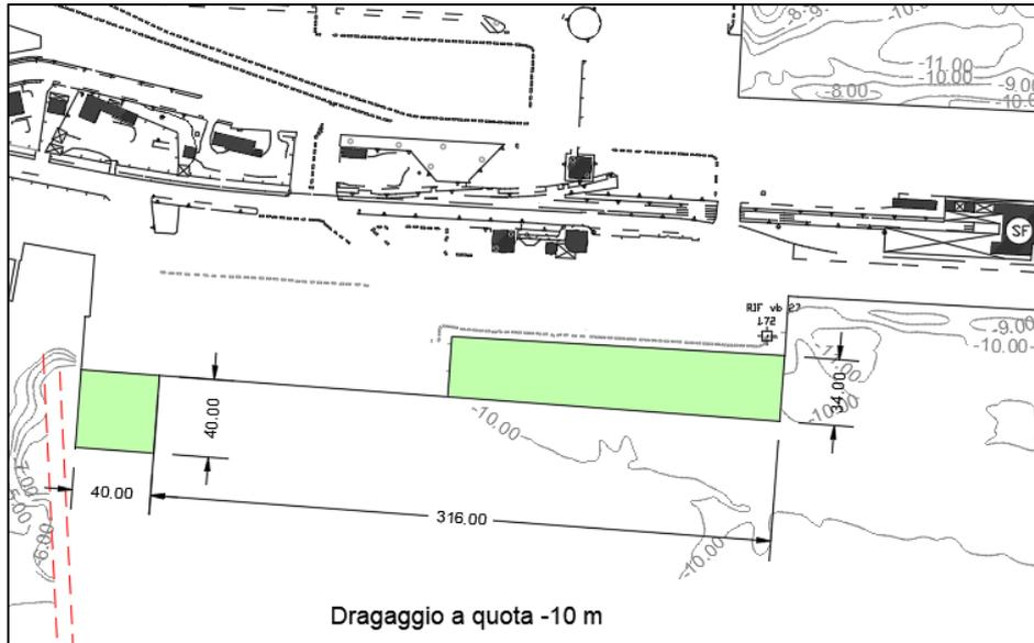
Figura 10: Pontile Isola Bianca: Vasche di colmata attracchi 8 e 9. Da ATF proposto dall'AdSP
