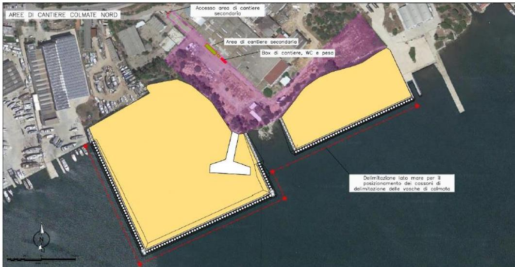
Figura 40: Aree di cantiere a terra (in rosa) delle Colmate Nord (Fonte: Prime indicazioni e disposizioni per la stesura dei piani di sicurezza)
