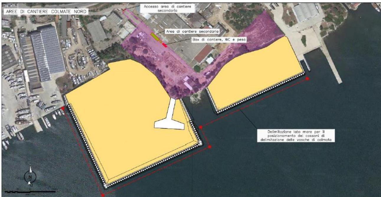
Figura 16. Aree di cantiere delle Colmate Nord (Fonte: Prime indicazioni e disposizioni per la stesura dei piani di sicurezza)
