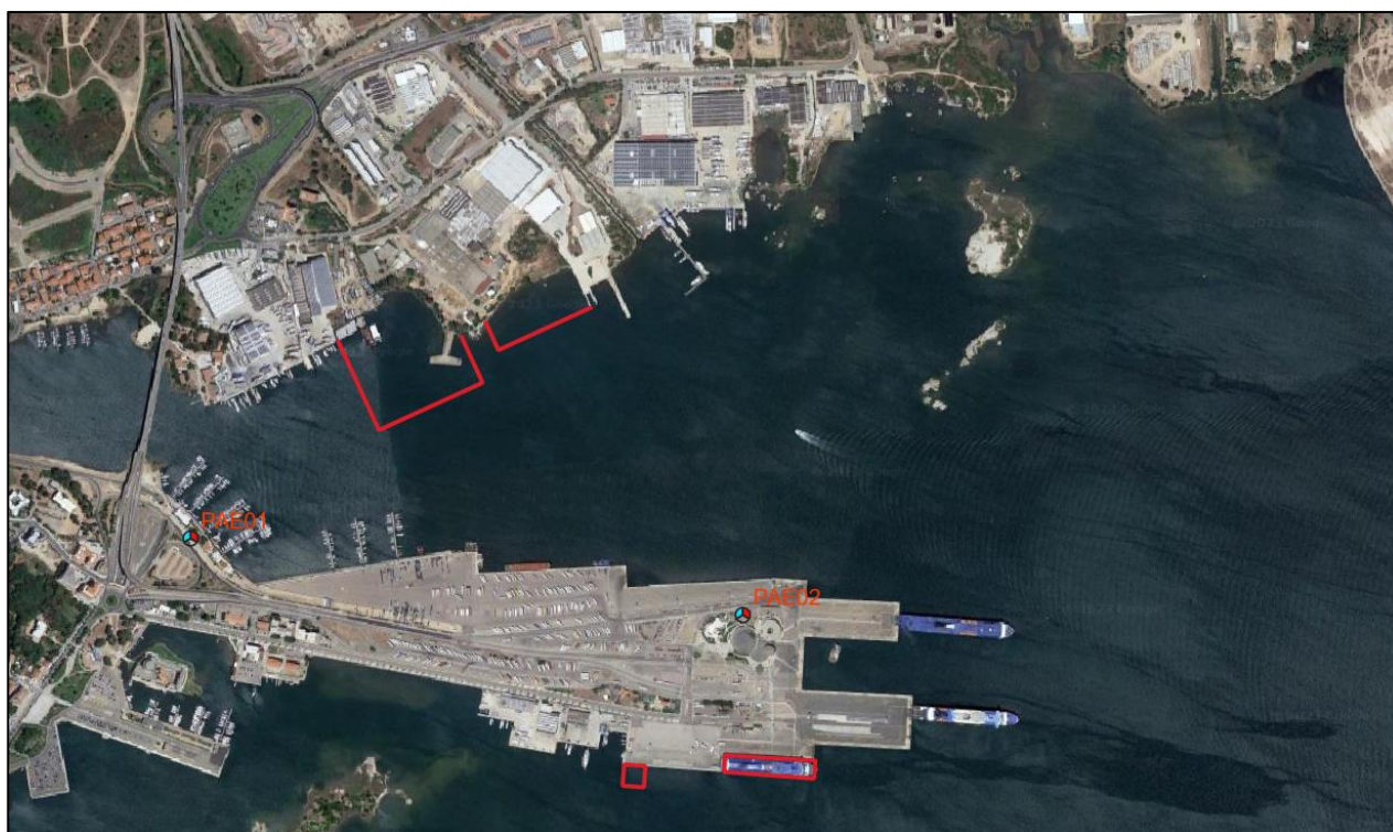
Figura 12: Localizzazione punti di misura PAE (in rosso le aree adibite alle vasche di colmata e in blu l'area generale interessata dalle attività di dragaggio)
