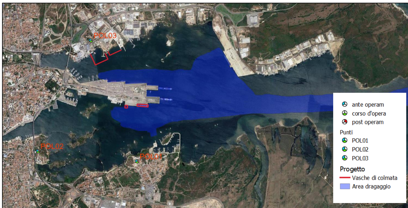
Figura 10: Localizzazione punti di misura POL (in rosso le aree adibite alle vasche di colmata e in blu l'area generale interessata dalle attività di dragaggio)
