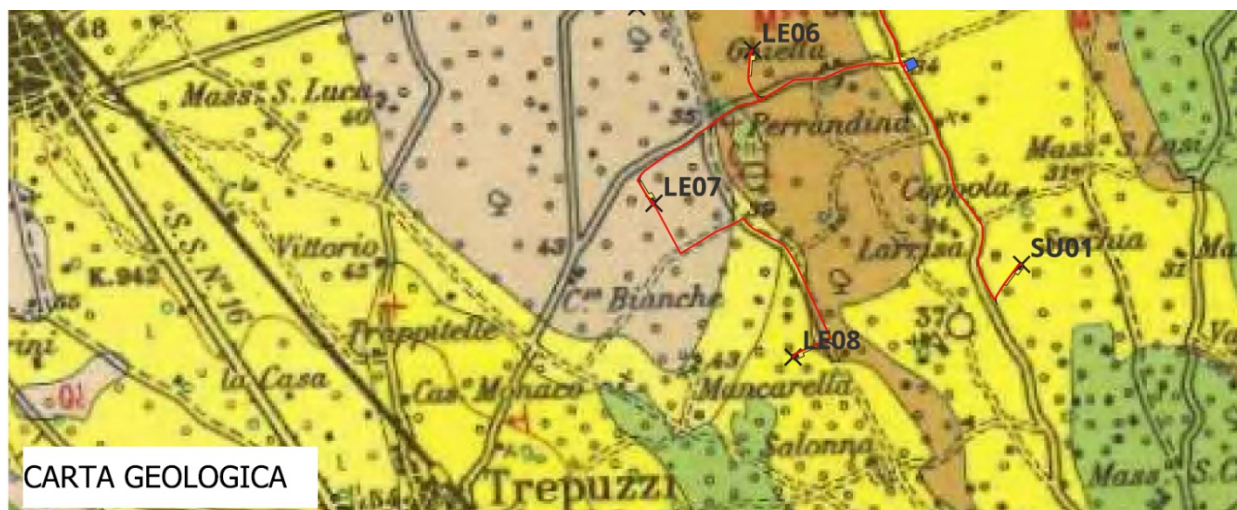
Inquadramento geologico di dettaglio Area Sottostazione Elettrica e cavidotto (Foglio 203 BRINDISI) Carta Geologica 1:100.000)
