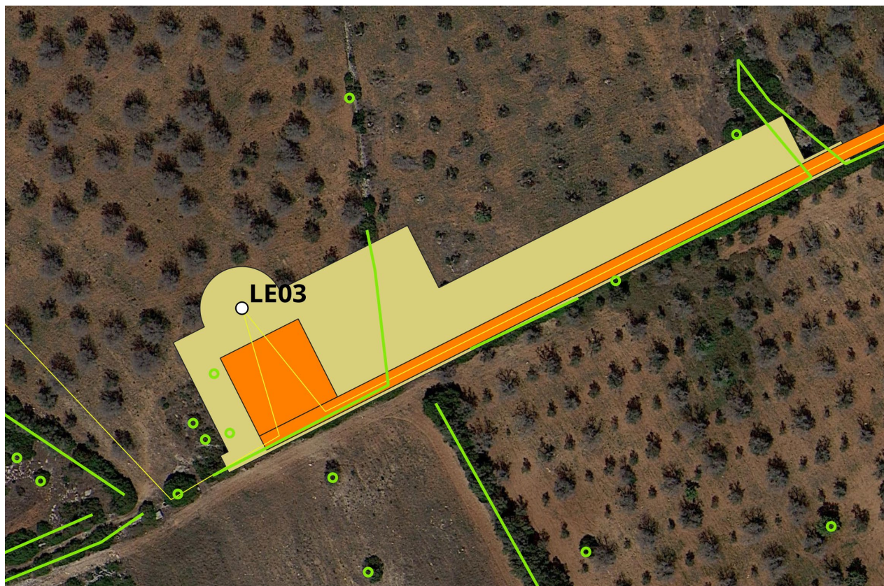
Ulivi selvatici da espantare per la realizzazione della piazzola di cantiere. Coordinate inizio filare: 40°27'12.779"N 18°5'41.619"E, 40°27'14.999"N 18°5'43.563"E, 40°27'16.436"N 18°5'48.059"E
