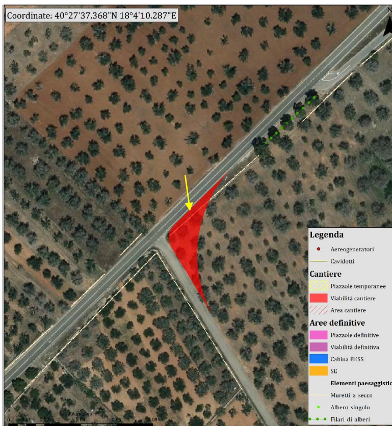
Figura 22: Interferenze con muretti a secco per la realizzazione della viabilità di cantiere alle coordinate 40°27'37.368"N 18°4'10.287"E, nel comune di Lecce (LE)
