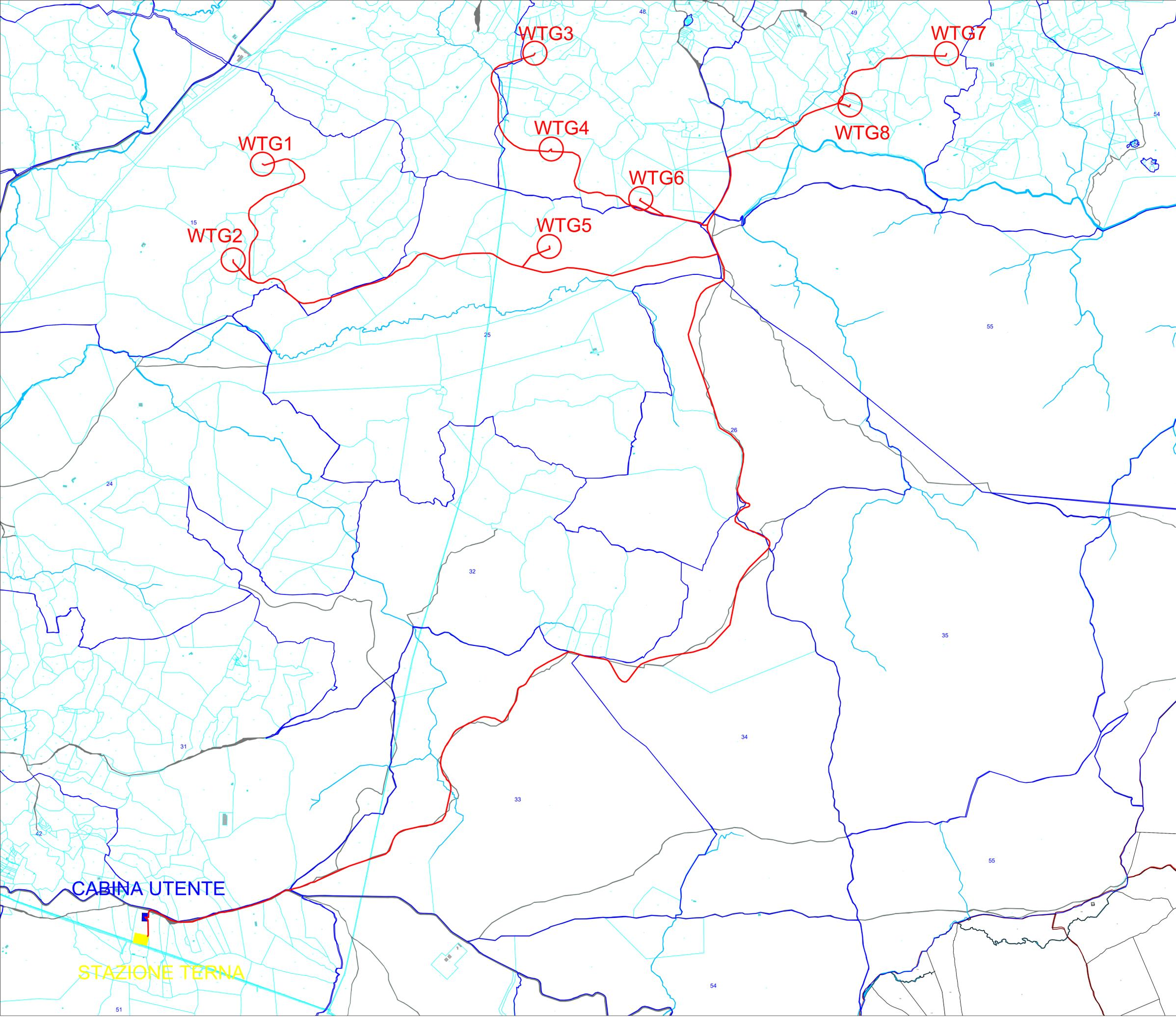
La DPA calcolata è pari a 1,5 m che si riduce a 0,86 m per effetto dell'interramento del cavidotto a 36 kV
