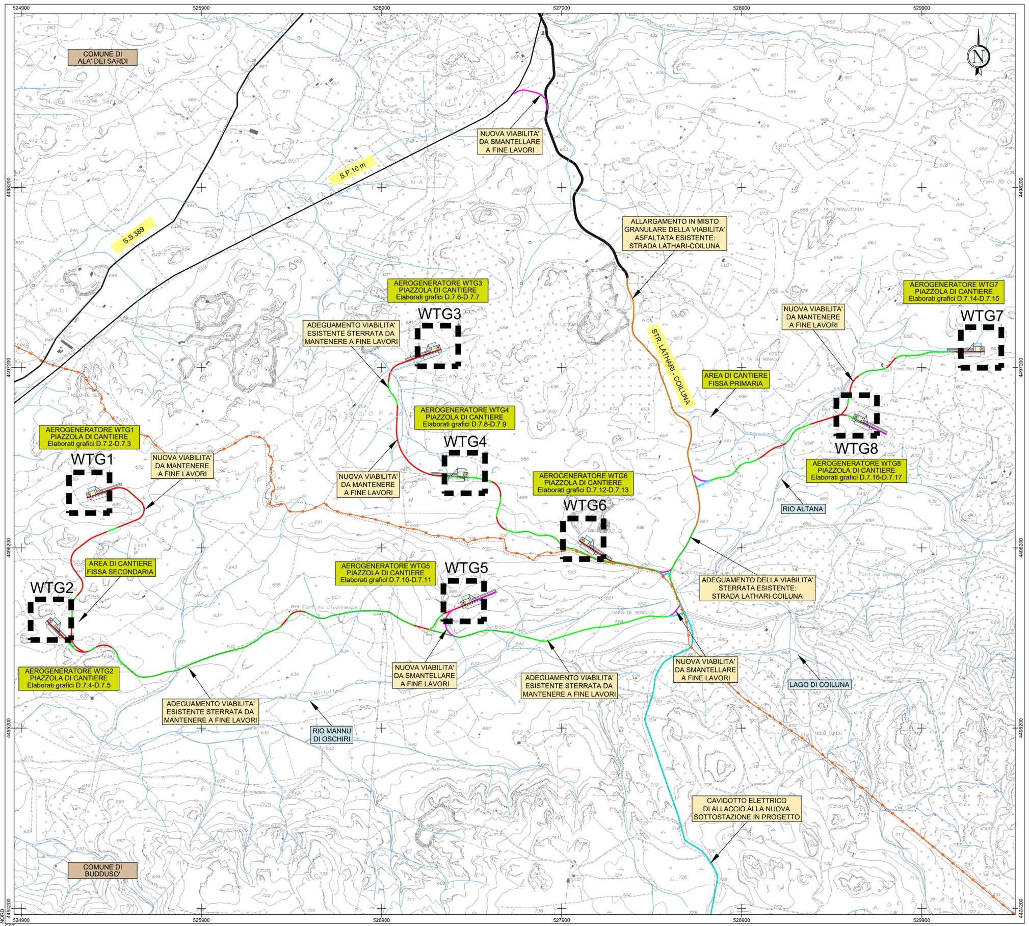
PLANIMETRIA GENERALE DELLE PIAZZOLE DI CANTIERE E DELLE NUOVE VIABILITA'
