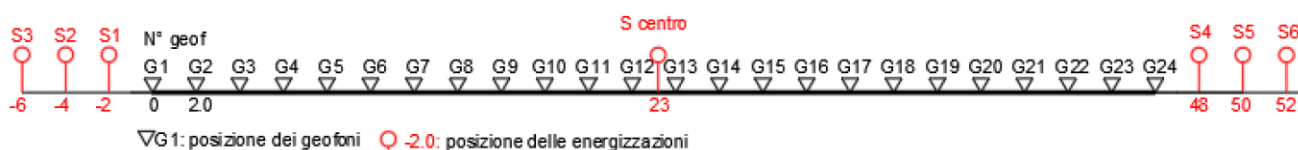
Figura 9-1 Schema geometrico di acquisizione dei dati per gli stendimenti di lunghezza L = 46,0 m
