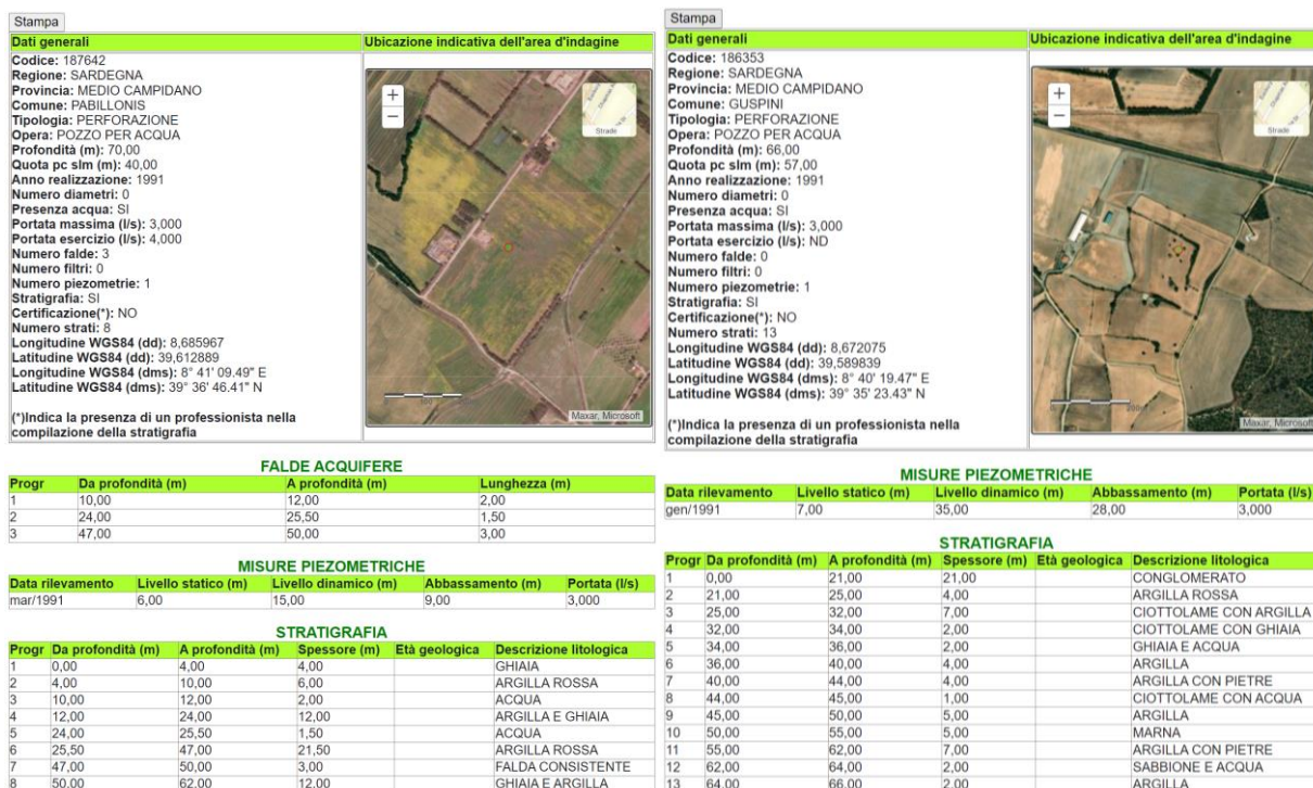
Figura 5-2 Falde rilevate nelle perforazioni cod. 187642 (A1) – 186363 (A2)
