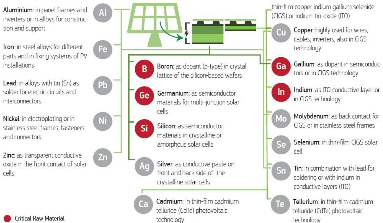
**Figura 2 - Materie prime utilizzate nelle tecnologie del solare agrivoltaico**
