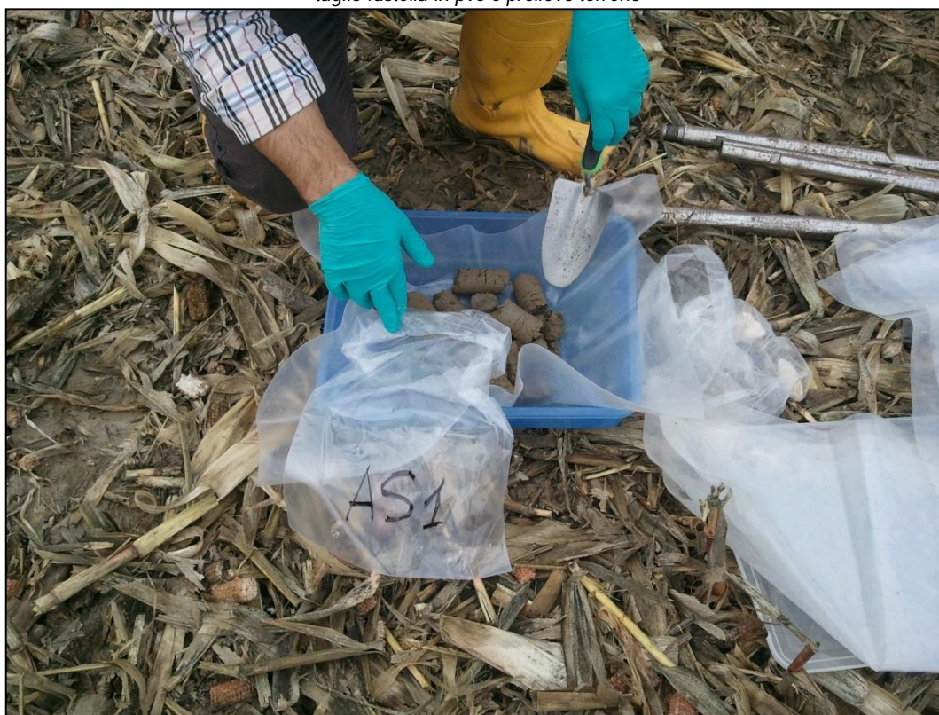
Esempio miscelazione incrementi di terreno e preparazione campione per analisi
