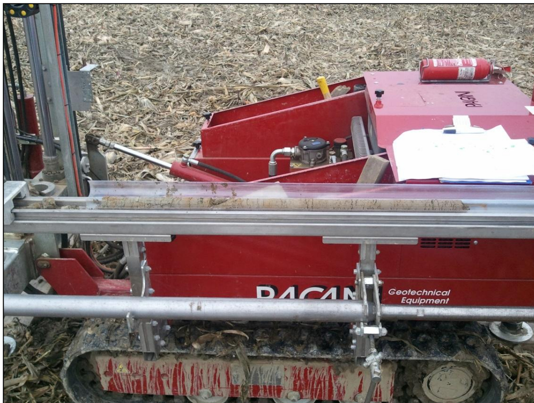
taglio fustella in pvc e prelievo terreno
