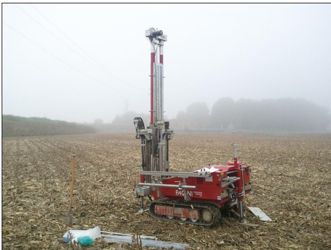
Esempio esecuzione sondaggio a carotaggio continuo
