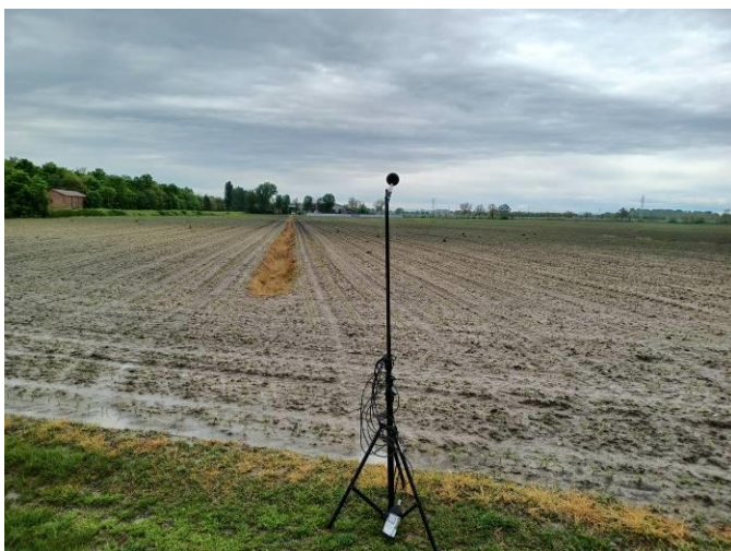
Postazione microfonica durante il rilievo di rumore residuo
