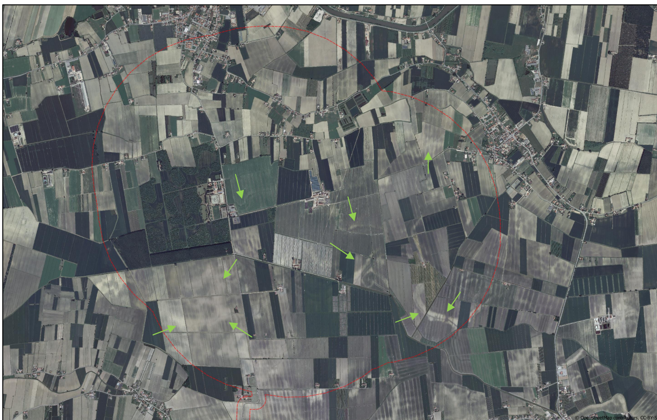
Ortofoto del 2012. Le frecce verdi indicano le anomalie meandriche, rami di rotta o antichi canali naturali.
