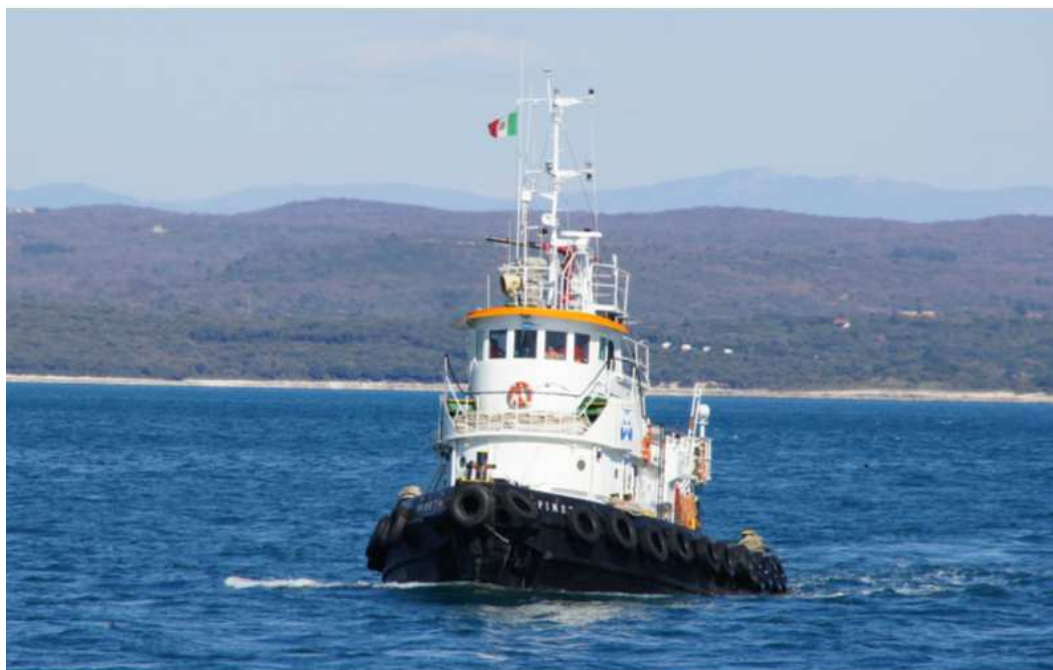
Figura 3-44: tipico di rimorchiatore salpa-ancore
