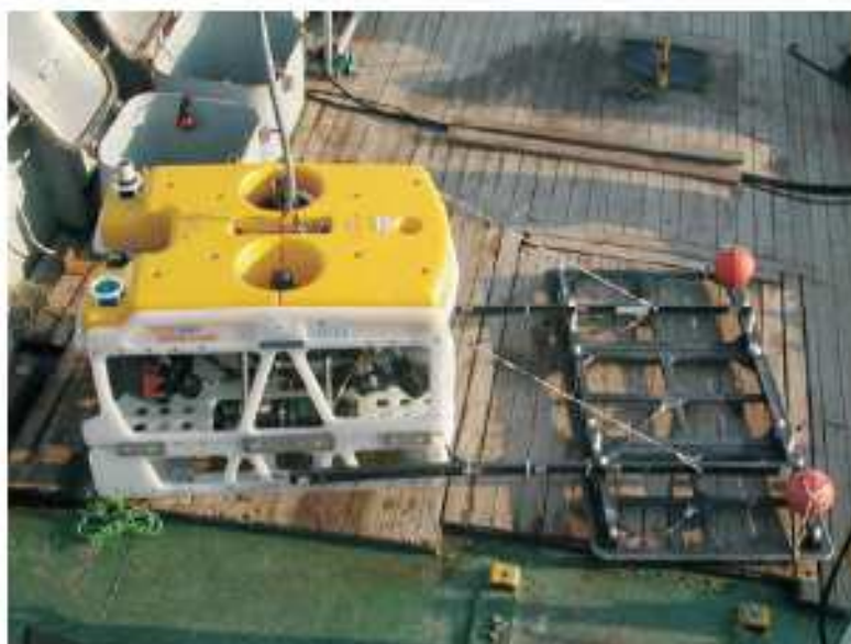
Figura 3-48: tipico di veicolo subacqueo per indagini sottomarine (R.O.V.)
