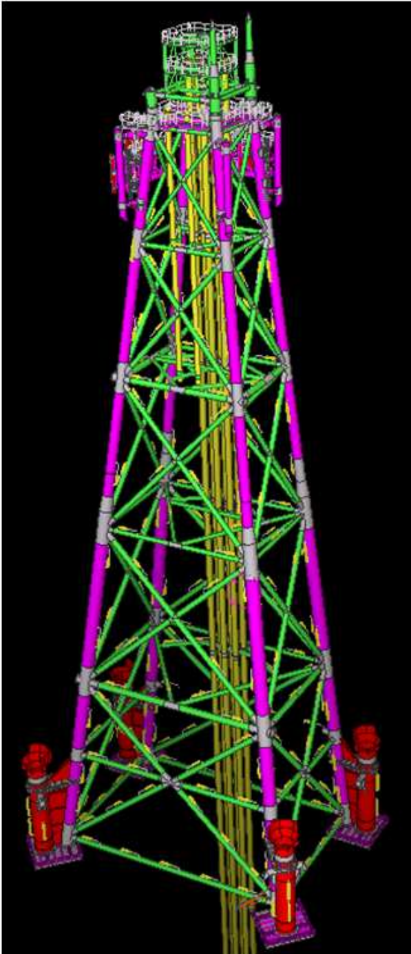
Figura 3-49: struttura del Jacket a 4 gambe con sleeves
