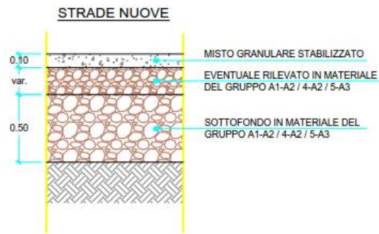
Figura 5.1: tipico per viabilità di nuova realizzazione
