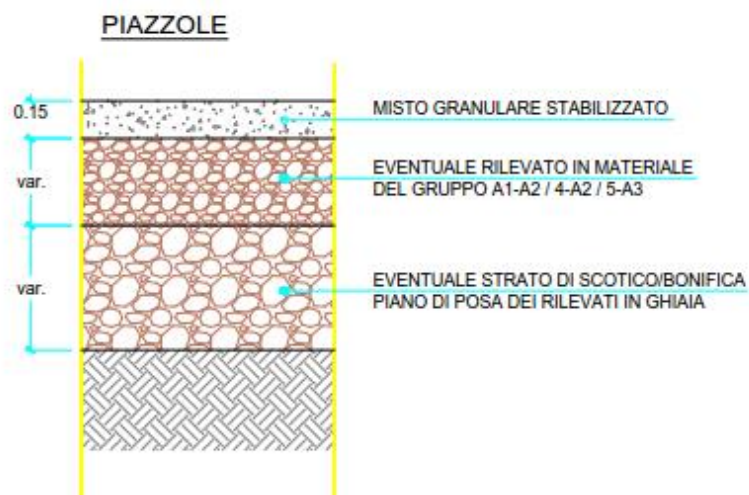
Figura 5.3: sezione tipo delle piazzole
