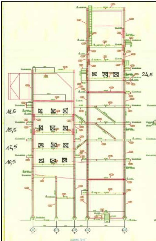
I soffiatori sono apparecchiature retrattili che entrano nel DeSOx. Sono installati a vari piani in numero di 3 apparecchiature per piano per un totale di 15 (si veda Figura 7 in calce). Il ciclo di pulizia dell'assorbitore prevede l'entrata in servizio di un soffiatore alla volta.
