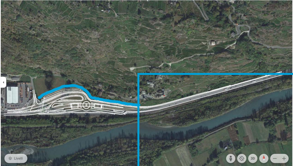
Figura 2-3 Planimetria di progetto, con fosso ripristinato in evidenza
