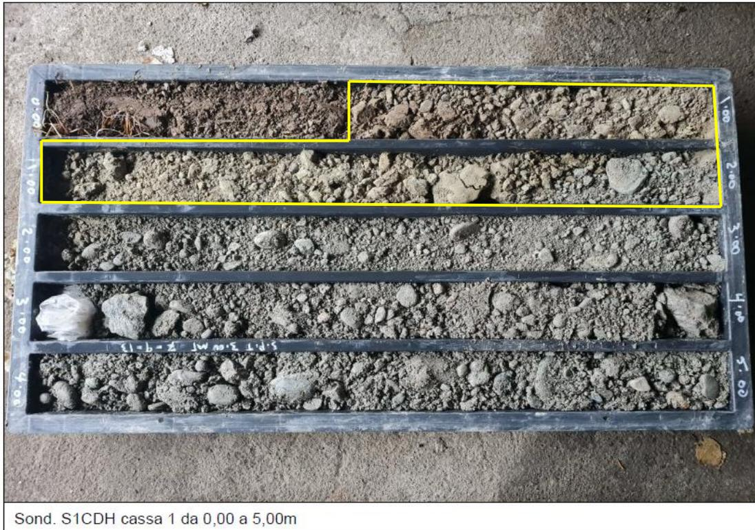
*Fig. 8.5– Cassa n. 1 del sondaggio S1CDH; la sabbia finissima limosa è compresa tra -0,5 m e -2,00 m.*
