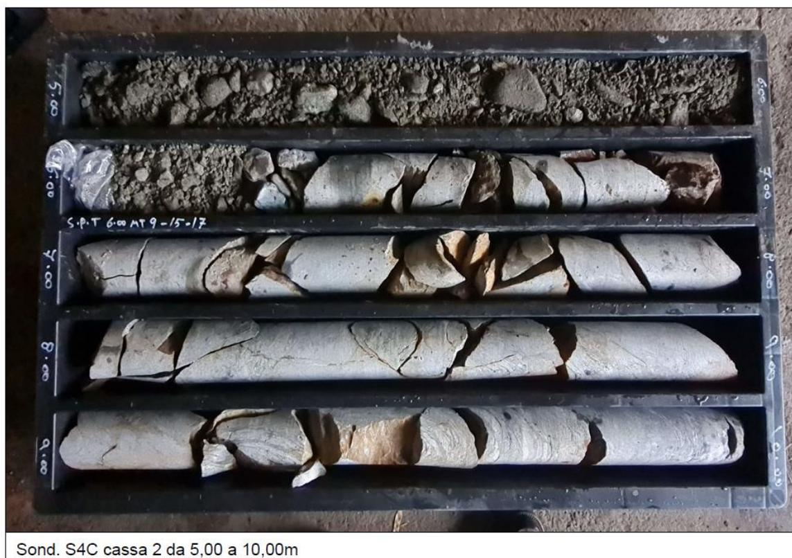
*Fig. 8.8 – Cassa n. 2 del sondaggio S4C; gli Scisti di Edolo sono presenti a -6,3 m al di sotto dei depositi alluvionali ghiaioso-sabbiosi.*
