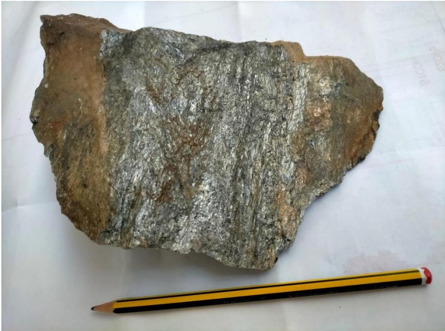
*Fig. 8.10 – Blocco appartenente agli Scisti di Edolo prelevato da un affioramento limitrofo al tracciato di progetto; sono evidenti i fittissimi piani di scistosità.*
