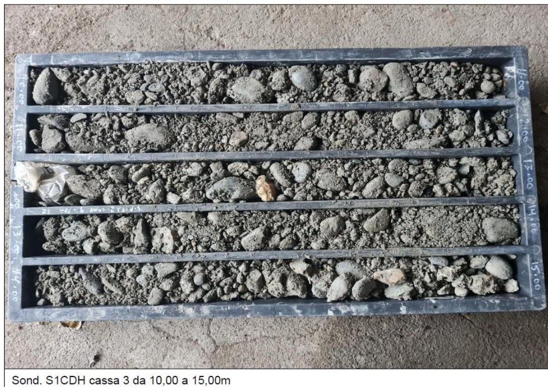
*Fig. 8.6 – Cassa n. 3 del sondaggio S1CDH; ghiaia e sabbia con ciottoli subarrotondati.*
