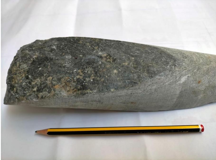
*Fig. 8.9 – Particolare di una superficie di scistosità di un testimone di carotaggio di Scisti di Edolo.*
