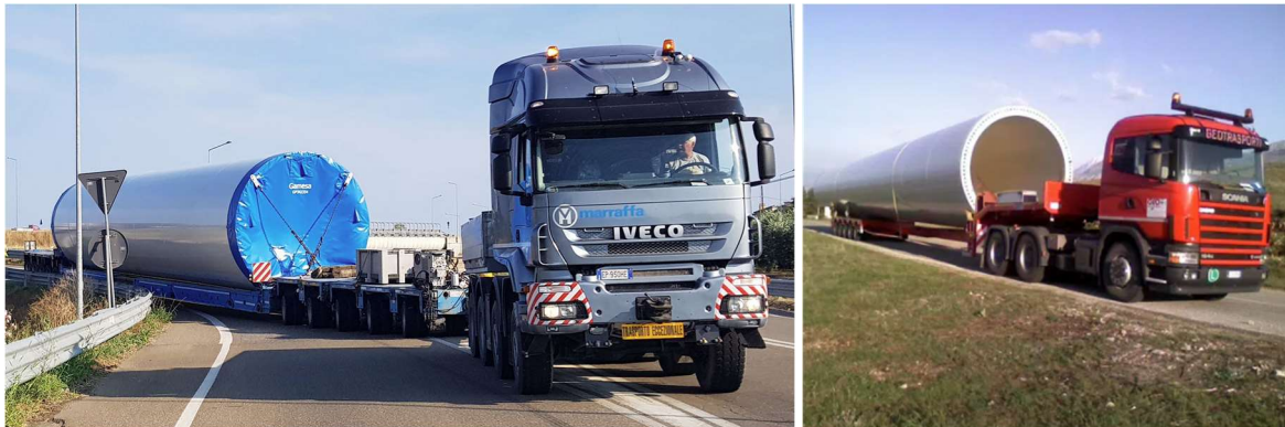
Figura 24 – Esempio di trasporto con convogli a pianale allungabile per conchi di torre
