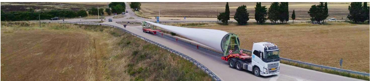
Figura 21 – Esempio di trasporto con SWC (Super Wing Carrier)
