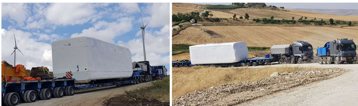
Figura 25 – Esempio di trasporto "Navicella"
