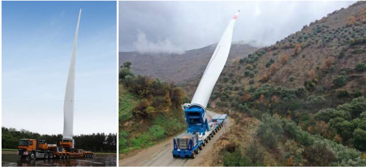
Figura 23 – Esempio di trasporto con Blade Lifter Trailer
