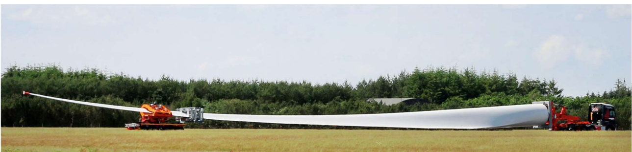
Figura 22 – Esempio di trasporto con "RBTS" (Rotor Blade Transport System)
