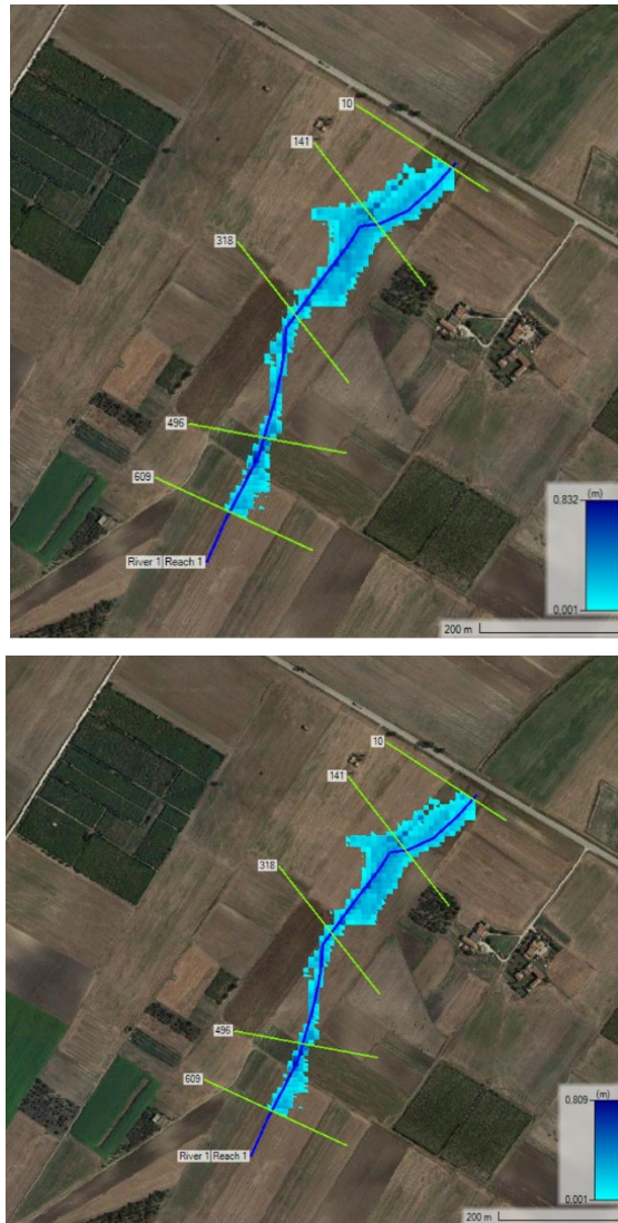
Figura 12 – altezze del tirante idraulico alla portata considerata con TR = 30, 200, 500
