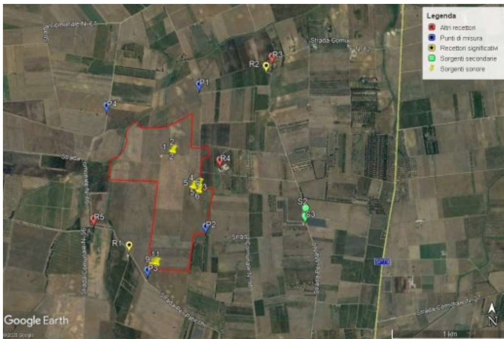
Fig.21- Zona d'influenza delle attività di cantiere con individuazione dei recettori (R) e punti di misura (P) considerati nella stima previsionale.
