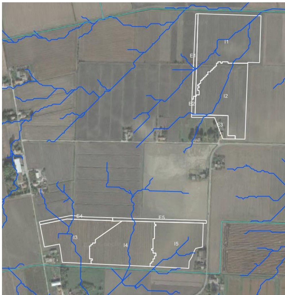
Figura 22: Delimitazione bacini scolanti (bianco), reticolo di drenaggio esterno ed interno alle sezioni di progetto (blu). Campi A e B
