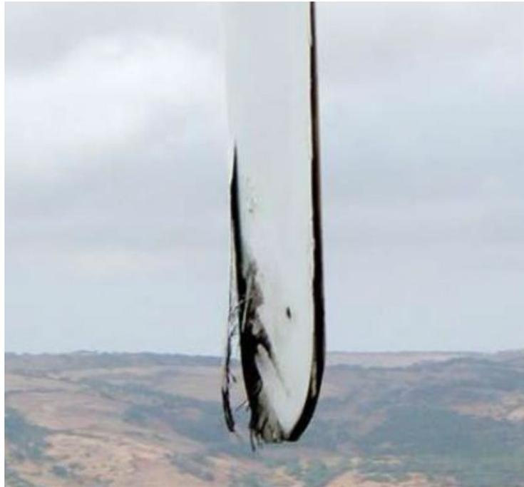
*Figura 2 - Estremità della pala danneggiata da fulminazione atmosferica*
