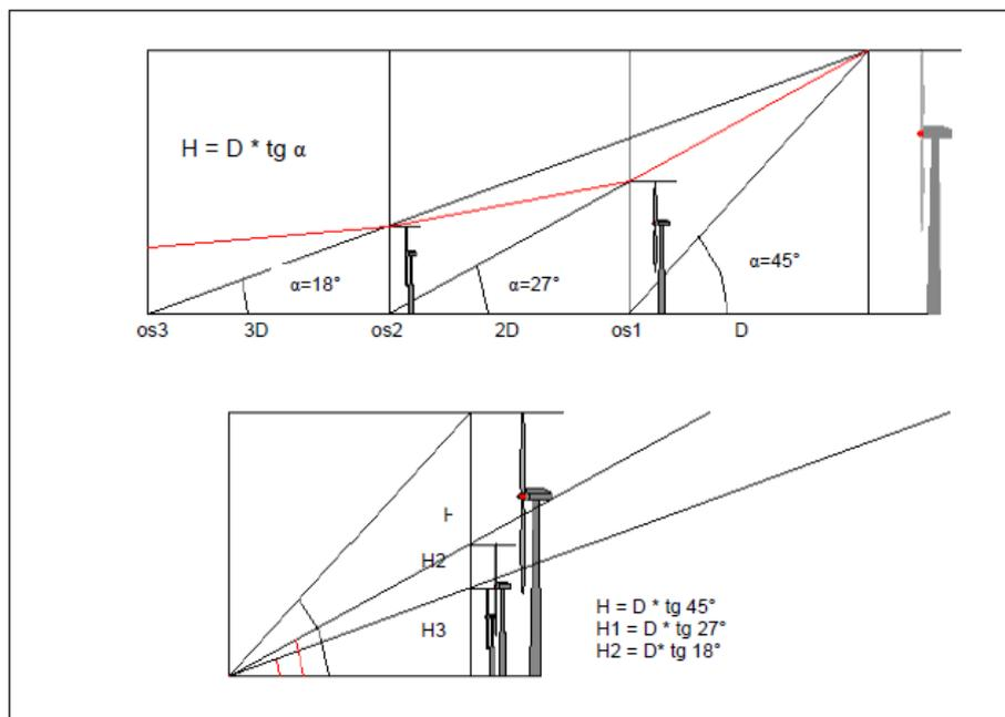
Figura 1 Schema di valutazione della percezione visiva
