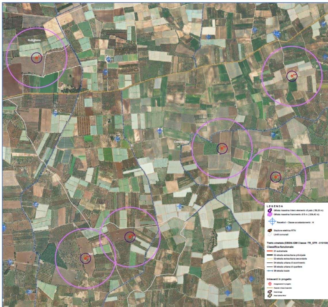
Figura 9 - Gittata elementi rotanti aerogeneratori in progetto
