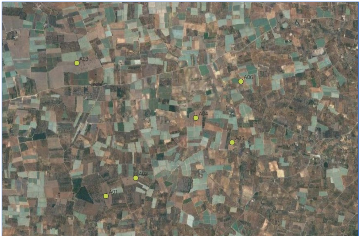
Figura 2 - Ipotesi Layout a 6 aerogeneratori con collocazione differente
