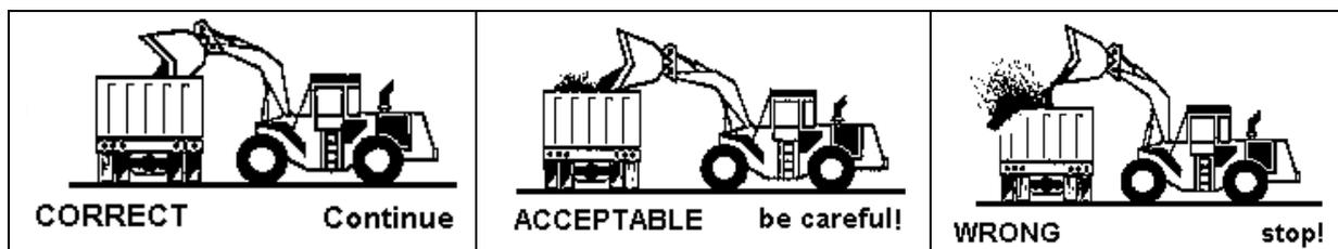
*Figura 40 – Esempio di corretto svolgimento delle attività di carico con pala meccanica*
