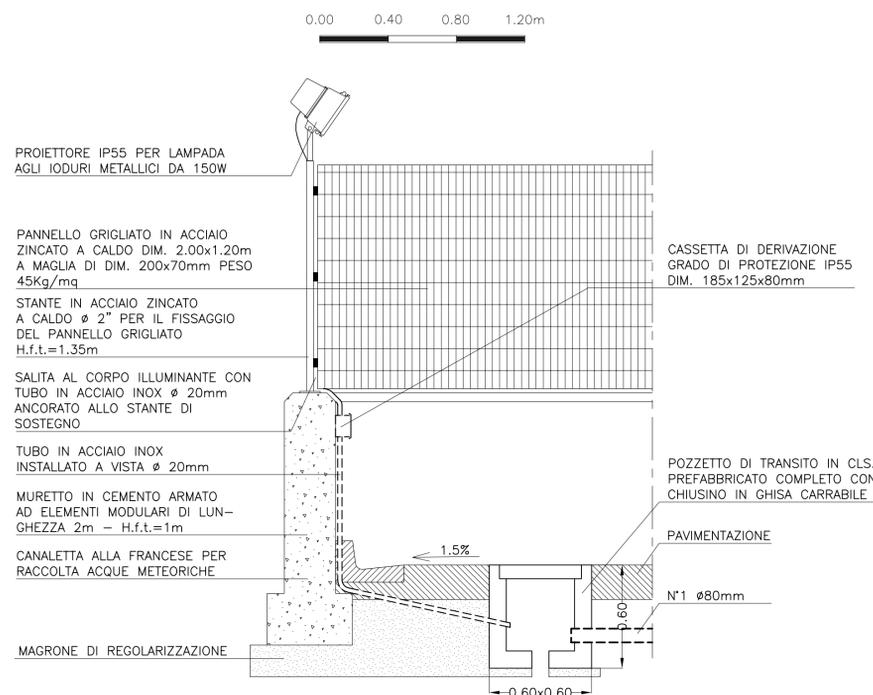
**PARTICOLARE POZZETTO DI RACCOLTA ACQUE METEORICHE**
