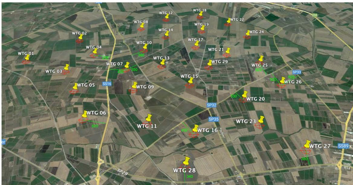
In questo caso remoto, di rottura a 5 metri dalla punta della pala, gli aerogeneratori rispettano le distanze di sicurezza con eccezione dell'aerogeneratore WTG20.
