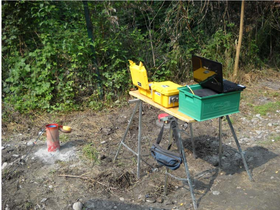
Figura 5. Strumentazione acquisizione dati Down-Hole
