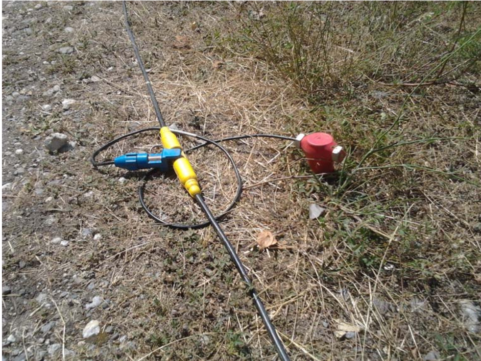
Figura 4. Geofono verticale collegato al cavo sismico.
