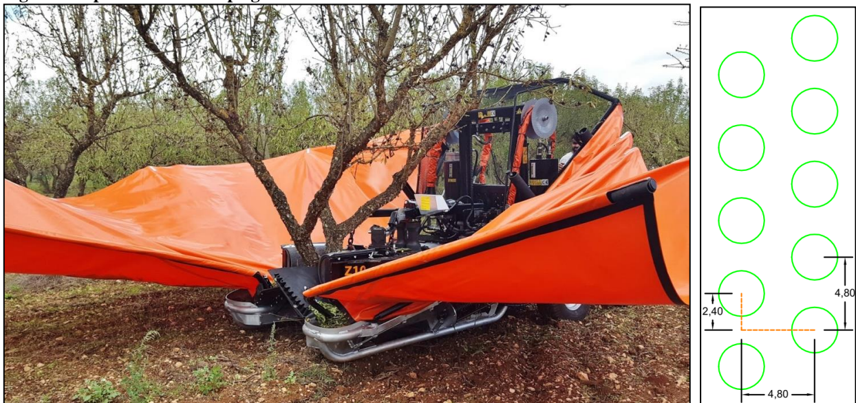
Figura 1. Macchina frontale per la raccolta delle mandorle/olive su impianto intensivo e disposizione ideale degli alberi per il corretto impiego della stessa
