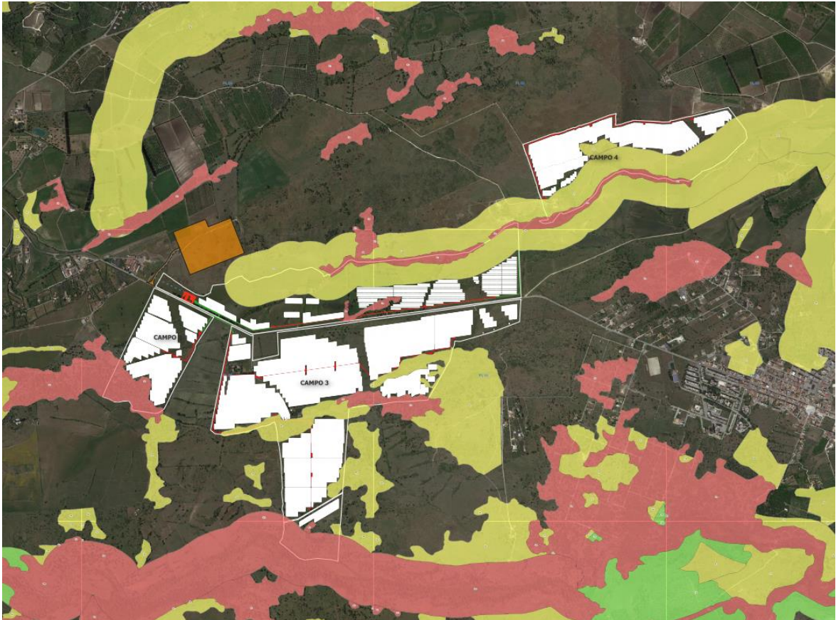
Figura 4 – Inquadramento impianto fotovoltaico e percorso cavidotto rispetto alle zone sottoposte a vincolo paesaggistico
