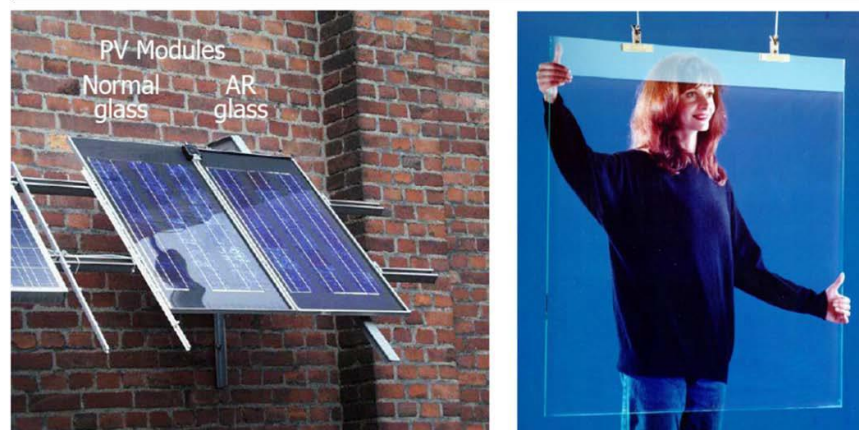
Figura 18 – Le due immagini dimostrano in modo lampante come, al contrario di un vetro comune (normal glass), il vetro anti-riflesso (Anti- Reflecting glass) che riveste i moduli fotovoltaici (Photo Voltaic Modules) riduca drasticamente la riflessione dei raggi luminosi
